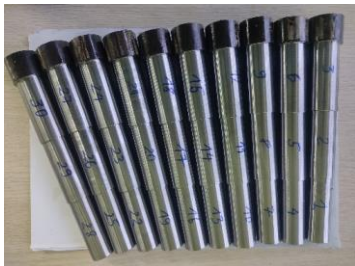
Hình 6. Sản phẩm mẫu thử sau khi gia công
