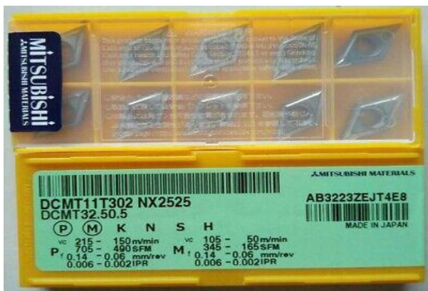
Hình 4. Hạt cắt lựa chọn để sử dụng cho quá trình thực nghiệm trên máy tiện CNC Roturn 400C
