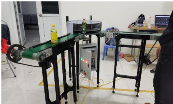
Hình 11. Modul chiết rót và băng tải
