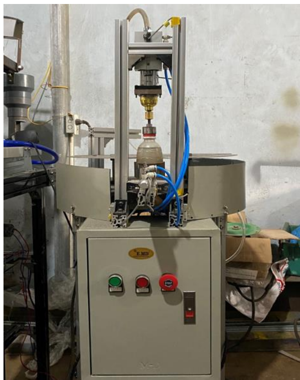
Hình 13. Modul đóng nắp
